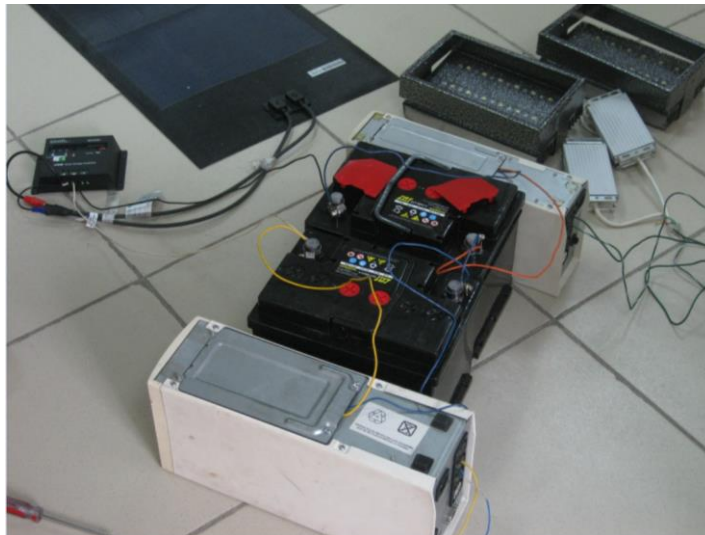
Рисунок 3.2 – Общий вид собранной в тестовом режиме системы освещения
